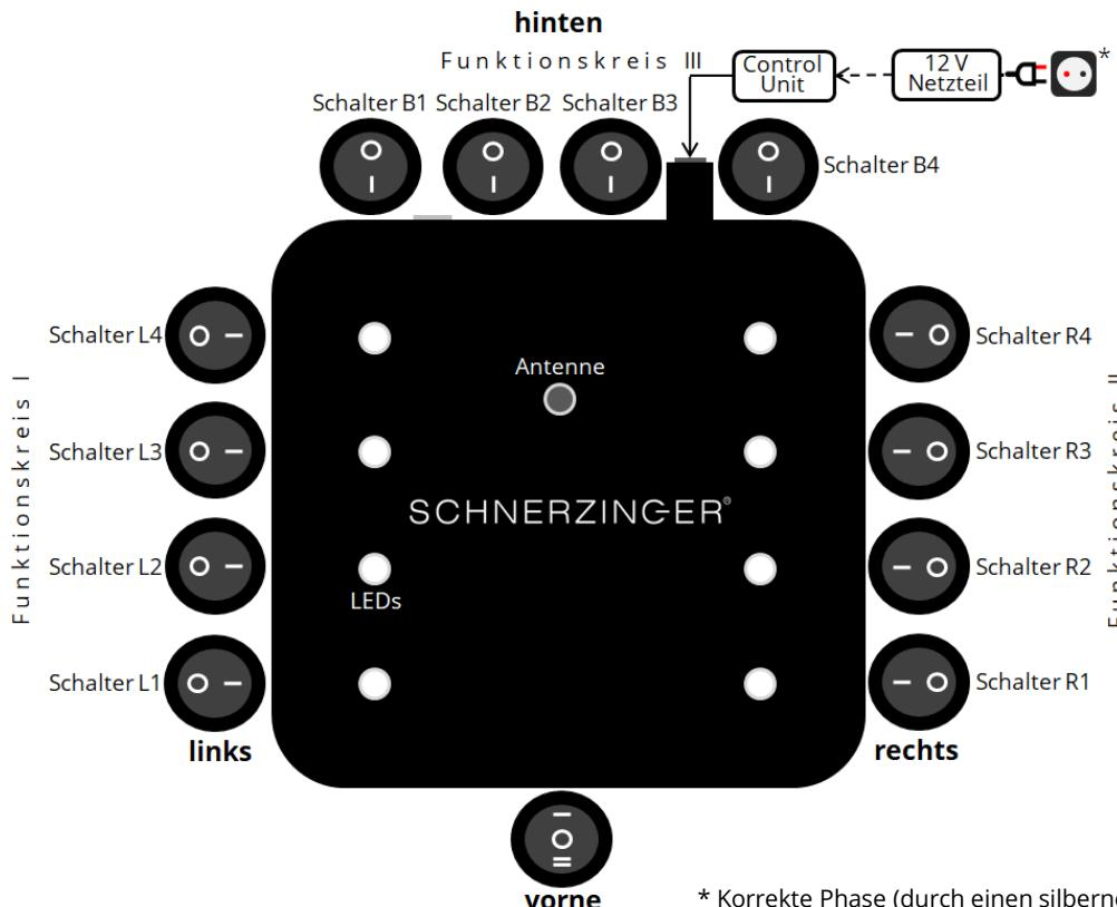
Ausgehend von der Grundstellung werden die Schalter L1 - L4 der Reihe nach von Stellung 0 in Stellung 1 gebracht. Mit jedem Schritt wird die Bandbreite erhöht.
